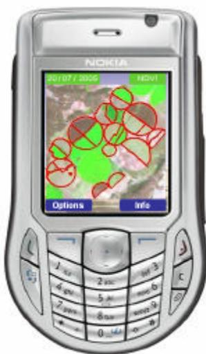
Figura 5.- Acceso a la información generada por el sistema e-SARAS<sup>®</sup> mediante teléfono móvil, tanto información gráfica como numérica, en similar forma a la que se puede acceder mediante internet.
