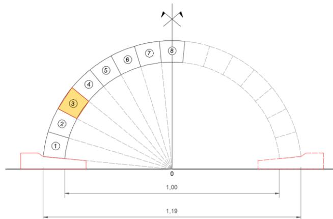
El arco terminado constará de 15 dovelas para conformar el montaje ilustrado en la imagen anterior. A cada grupo participante se le hará entrega de un máximo de 19 dovelas, por lo que deberán descartar las piezas menos adecuadas antes de proceder al montaje del arco, a fin de no comprometer su estabilidad. No se suministrará ni se podrá hacer uso de ninguna pieza a modo de cimbra ni apeo temporal.
