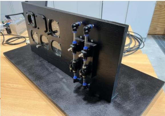
Diseño y fabricación de un sistema automático de gestión de presiones barométricas en un demostrador de panel de instrumentos de vuelo en un avión ligero
