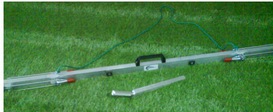
Figura 6.12. Regla de 3 metros y cuña para el ensayo de regularidad de la superficie.
