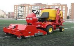
Figura 2.18. Diferente maquinaria de descompactación de la superficie
