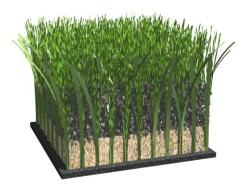
Figura 2.6. Corte transversal de un campo de fútbol de césped artificial sin base elástica
