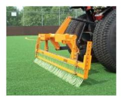
Figura 2.17. Sistema de cepillado de la superficie para mantener la verticalidad de la fibra
