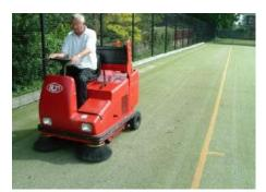
Figura 2.15. Sistema de limpieza de la superficie de césped artificial
