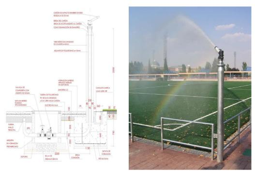
Figura 7.5. Sistema de aspersor situado a 2m. de altura
