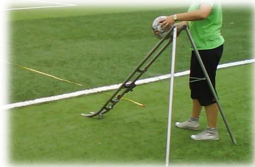
Figura 2.5. Ensayo de Rodadura Horizontal de balón
