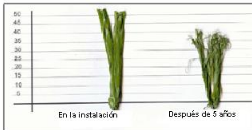
Figura 1.17. Degradación de la fibra tras su instalación ocasionado por el uso (Abbott, 2007)
