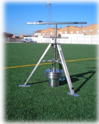
Figura 2.3. Equipo de ensayo de Tracción Rotacional
