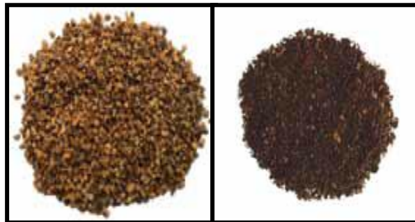
Figura 1.11. Relleno orgánico de corcho (izquierda) y fibra de coco con cáscara de nuez (derecha)
