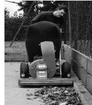
Figura 1.19. Sistema de limpieza del pavimento
