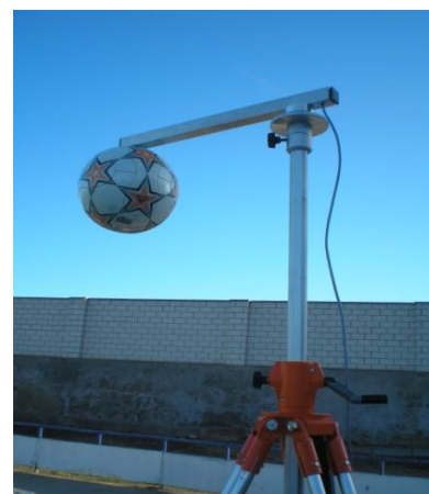
Figura 2.4. Ensayo de Bote Vertical de balón
