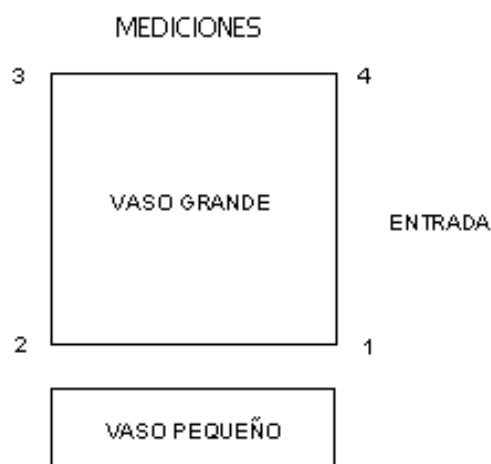
Figura 2.1. Puntos de medición de concentración de cloro en la atmósfera en las piscinas cubiertas.
