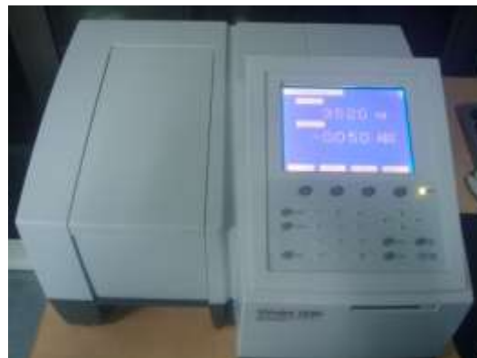
Figura 2.3. Espectrofotómetro UV-Visible utilizado para las mediciones de absorbancia.
