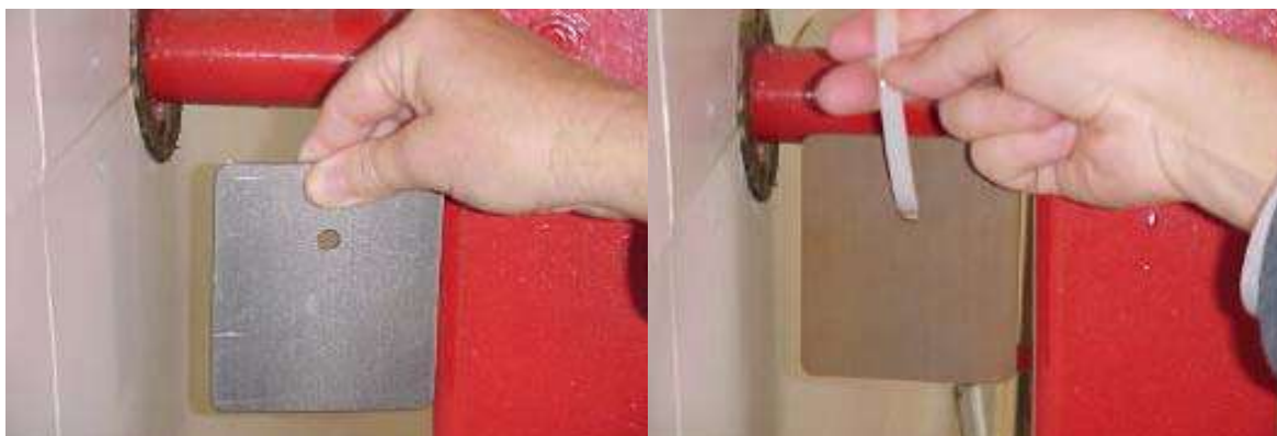
Figura 1.4. Corrosión ejercida por el cloro en una placa de acero en 4 días (Gomá, 2001).
