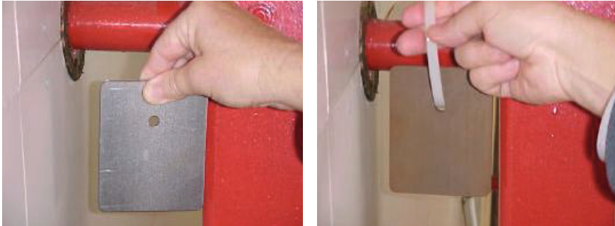
Figura 7.2. Corrosión ejercida por el cloro en una placa de acero tras 4 días (Gomá, 2001)
