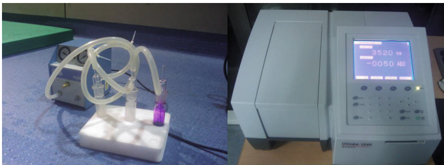
Figura 2.1. Bomba de aspiración, impingers con reactivos y espectrofotómetro UV visible
