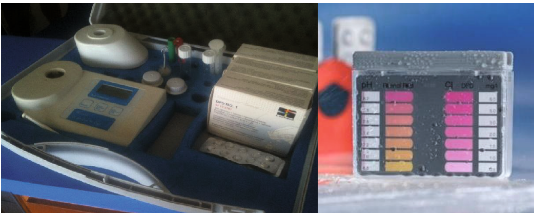
Figura 1.5. Métodos de medición Manual del tratamiento químico por colorimetría. Fotómetro portátil y cubeta de análisis
