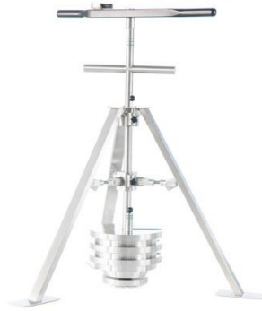
Figura 10. Equipo de medición de la tracción rotacional (Imagen de Deltec®)
