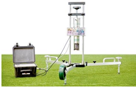
Figura 8. Atleta Artificial Avanzado (Imagen de Deltec®)
