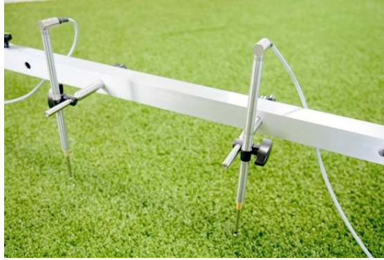
Figura 9. Sensores de desplazamiento que se incorporan al Atleta Artificial para analizar la deformación vertical de los pavimentos (Imagen de Deltec®)
