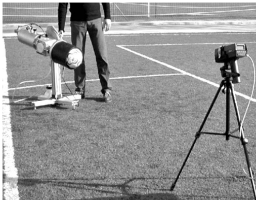
Figura 1.27. Cañón y radar empleado en el bote angulado de balón.
