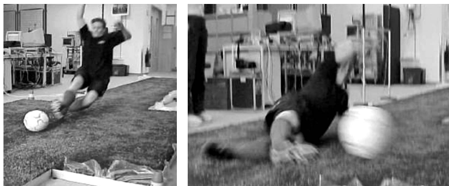
Figura 1.24. Ensayo de abrasión de la piel sobre césped artificial.
