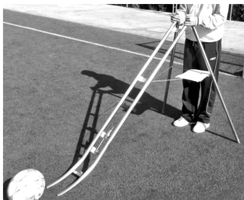
Figura 1.25. Ensayo rodadura de balón.
