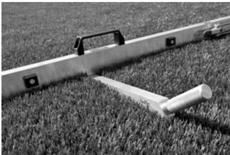
Figura 1.17. Figura del equipo de ensayo de planimetría montado sobre un pavimento.
