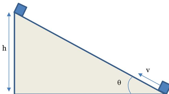
Solución: Por cinemática podemos determinar la aceleración  $v^2=v_0^2+2ae \rightarrow a=-9/(2*0.75) \rightarrow a=-6\text{m/s}^2$  (frenado)
