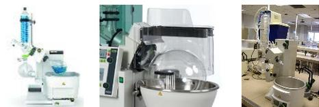
El rotavapor es un aparato de destilación rotatorio asociado a un baño María que es usado principalmente en laboratorios de química y bioquímica. Permite separar por evaporación a presión reducida y suave, el disolvente que acompaña al soluto de interés; o bien, para realizar destilaciones fraccionadas.
