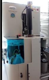
La porosimetría por inyección de mercurio se utiliza para la caracterización del sistema macroporoso de los materiales. Aplicando presión, se fuerza la entrada del mercurio en el entramado poroso del sólido. Se determina el área, el volumen de macro y mesoporos y se calcula la distribución de la porosidad del material.
