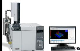
La cromatografía de gases (GC) es una técnica analítica que se utiliza para separar y analizar compuestos volátiles de una mezcla. Se utiliza como fase móvil un gas que arrastra los diferentes componentes de la muestra a través de la columna cromatográfica donde son separados por la combinación de diversos procesos de interacciones físicas y/o químicas entre los componentes de la muestra y la fase estacionaria.
