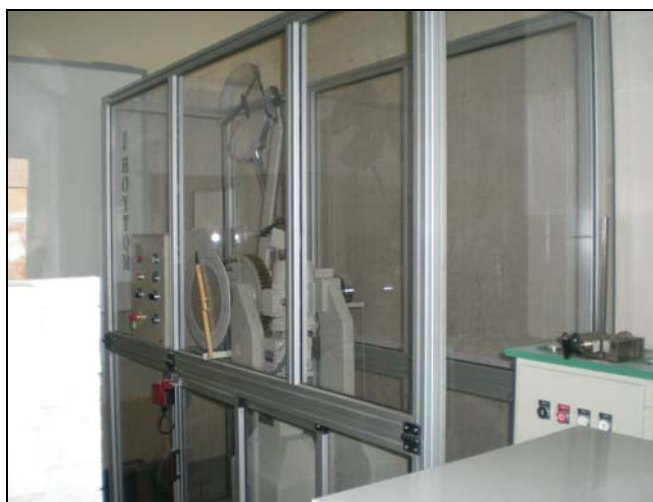
El mismo equipo con protección.
