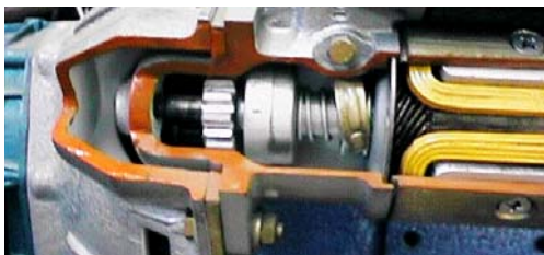
Figura 20.- Mecanismo de conexión por efecto de inercia.
