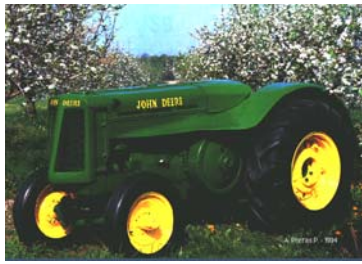
Figura 23.- Tractor adaptado a frutales.
