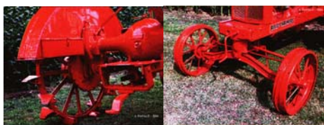
Figura 11.- Toma de fuerza y eje delantero basculante
