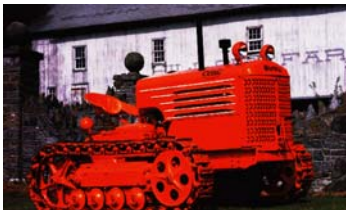
Figura 19.- Tractor oruga con cadenas altas.
