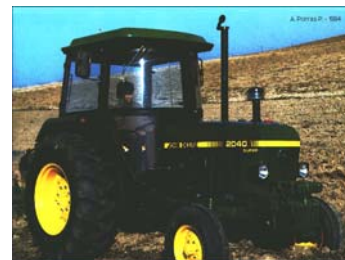
Figura 33.- Tractor 2 RM con cabina aislada y panorámica.
