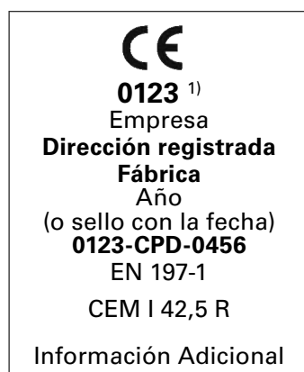
Figura A4.3a Ejemplo de etiquetado de cementos sujetos al mercado CE
